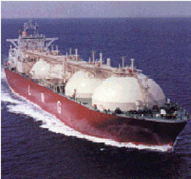
Buque gasero con tanques esféricos tipo MOSS (Fotografía cedida por B. Power)
