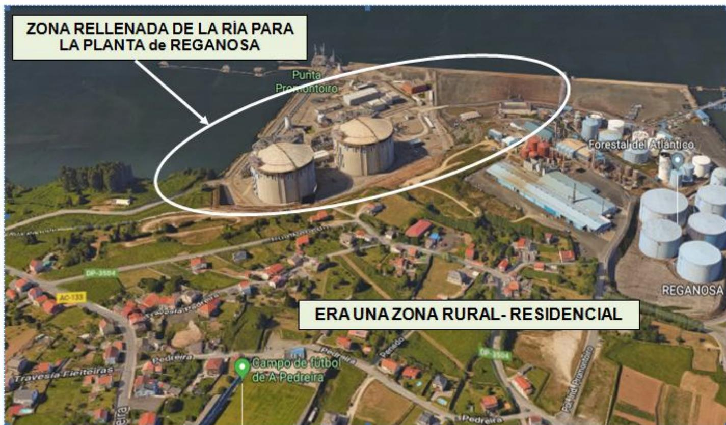
Fotografía aérea mostrando la Planta Regasificadora de gas licuado (LNG) e almacenes de combustibles
